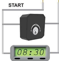
Il collegamento del comando di apertura START può essere effettuato a qualsiasi pulsante o contatto di tipo N.A. (normalmente aperto). Se vi sono più dispositivi, vanno collegati in parallelo.
